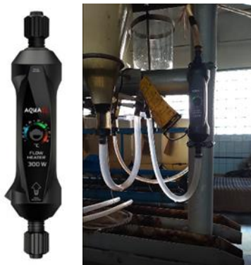
Рисунок 2. Система проточного подогрева воды.
