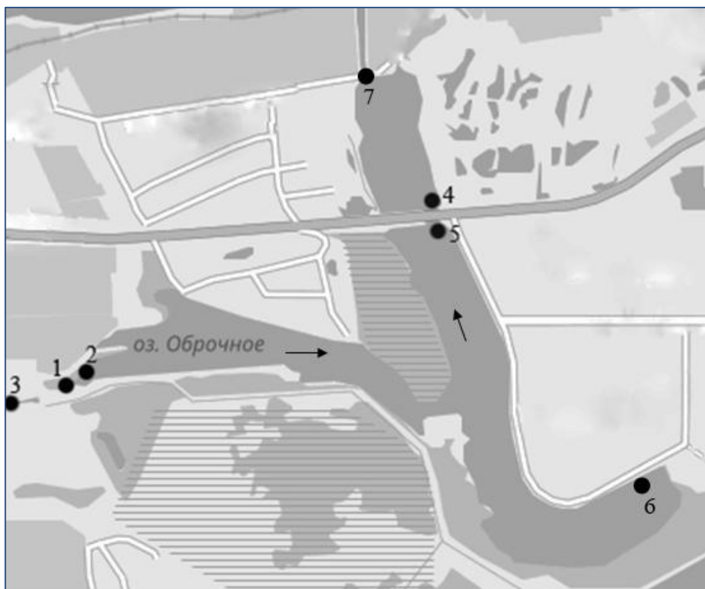
Рисунок. Схема водоема-охладителя Тюменской ТЭЦ-1 и станции отбора проб (стрелками обозначено направление течения).
