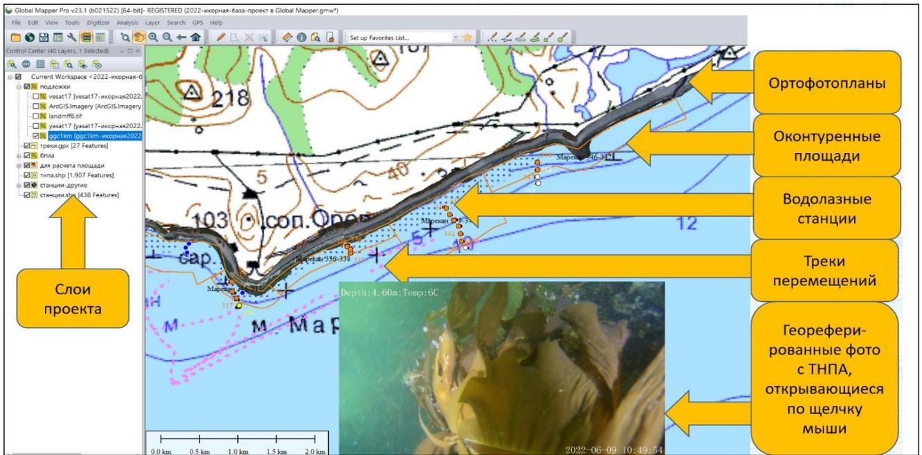
Рисунок 3 – Участок выполнения комплексной съемки у побережья СЗОМ в 2022 г. с результатами, систематизированными в геоинформационной системе
