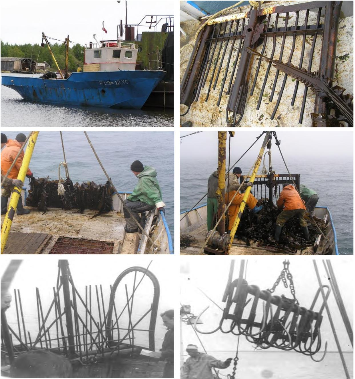
Рисунок 9.3.1 – Иллюстрации тралящих орудий добычи водорослей и работы с ними. Слева направо: а – бот, с которого вели промысел, б – гребенка, в – подъем гребенки, г – освобождение гребенки от улова (из: Дуленин, 2017а), д, е – конструкции фиктенов (из: Евсева, 2009)
