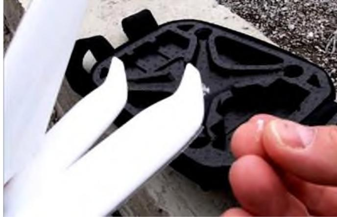
Рисунок 11 – Воздействие высокой влажности и низких температур на беспилотную технику. Видна кромка льда на пропеллерах
