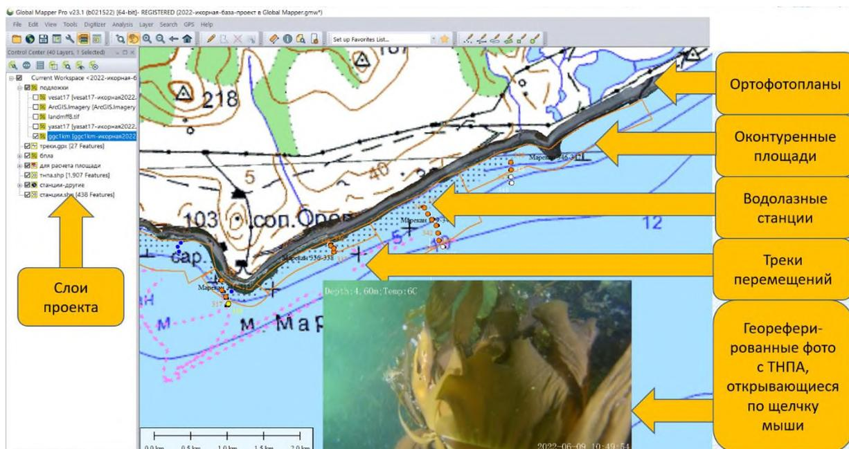
Рисунок 13 – Участок выполнения комплексной съемки у побережья СЗОМ в 2022 г. с результатами, систематизированными в ГИС. Оригинальные геореферированные подводные фото, атрибутивные данные станций, треков и полигонов, открываются в ГИС по щелчку мыши. Нужные слои с данными, ортофотопланы, векторные или растровые картоосновы добавляются или удаляются по мере необходимости
