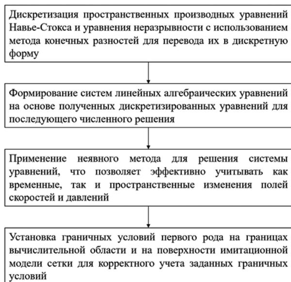
**Рисунок 5.** Алгоритм расчета гидродинамики узловых делей
