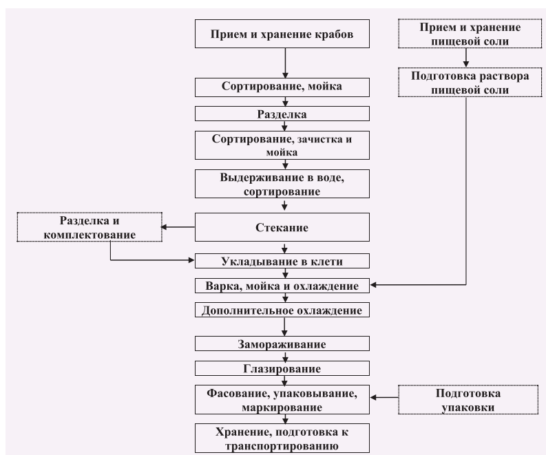
Рисунок 2. Технологическая схема изготовления крабов варено-мороженных рассольным способом замораживания
