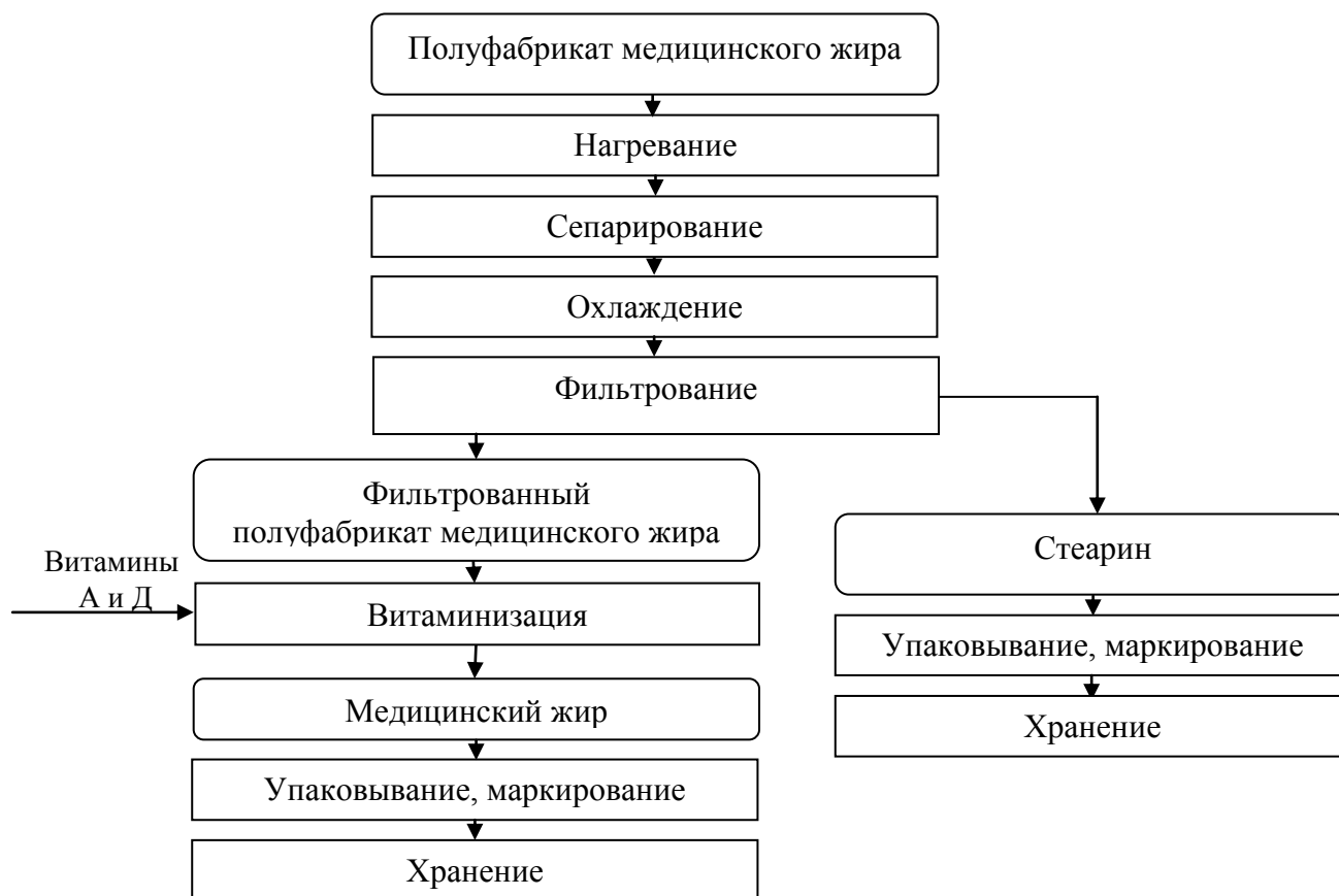
Рис. 5. Технологическая схема изготовления медицинского рыбного жира
