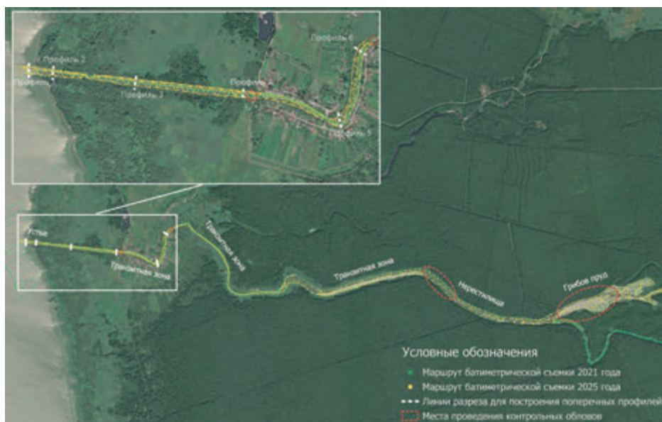
Рисунок 1. Карта-схема маршрутов гидроакустических съемок 2021 и 2025 годов, расположения поперечных створов и мест проведения контрольных обловов
