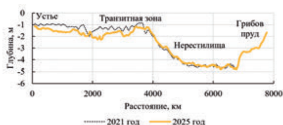
Рисунок 3. Продольные профили русла р. Промысловая, по данным батиметрических съемок 2021 и 2025 годов
