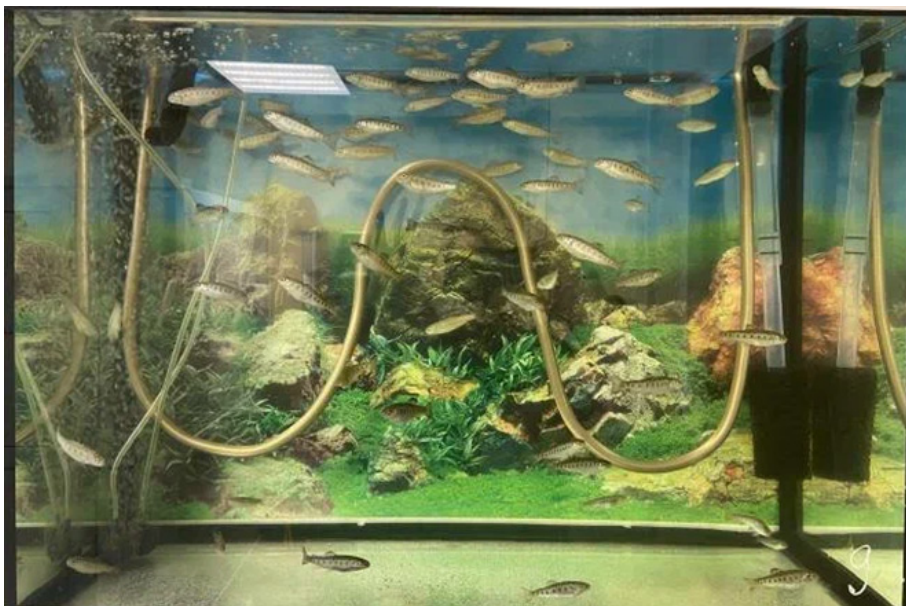
Рис. 4. Аквариум, его внутреннее оборудование и экспериментальные рыбы: у задней стенки видна трубка холодильной установки, слева шланги и распылители аэратора, справа водозаборная трубка с предохранительной губкой от засасывания рыб.
