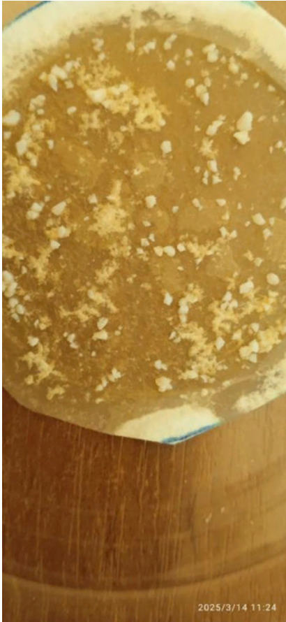
Рис. 2. Гранулы микропластика ПЭТ, после обработки пробы ЖКТ едким калием и фильтрации на целлюлозный фильтр.
