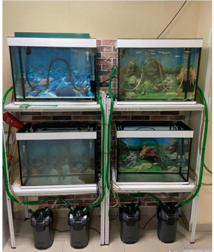
Рис. 3. 100 л аквариумы, которые использовались для контроля и двух серий эксперимента на молоди микижи. Внизу на полу располагались внешние фильтры – по одному на каждую ёмкость, к ним ведут шланги водозабора и возврата воды от трубок в аквариумах.
