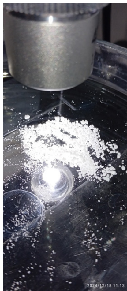
Рис. 1. Микропластик полиэтилентерефталат после измельчения на предметном столе бинокля.
